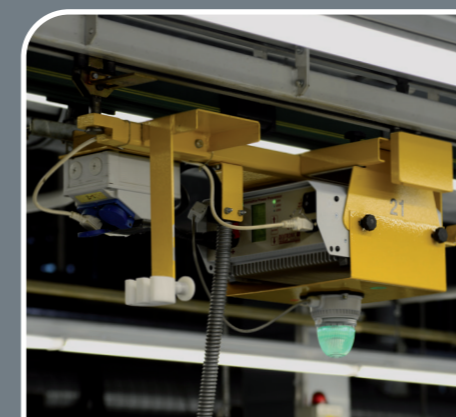
Einsatz Ladegerät mit Signallampe in der Fahrzeugfertigung
