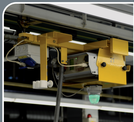
Einsatz Ladegerät mit Signallampe in der Fahrzeugfertigung
