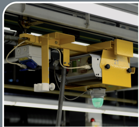
Einsatz Ladegerät mit Signallampe in der Fahrzeugfertigung
