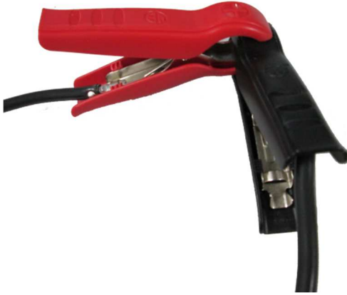
Resim 3: Kısa devredeki şarj kısıpacı
