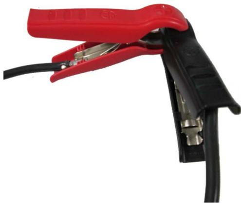
**Remarque:** Pour mieux déterminer la résistance du câble, les pinces doivent être serrées ensemble à angle droit afin que les deux mâchoires connectées aux câbles de charge soient superposées (voir Figure 3).
