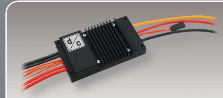
Die Motorregler der D-Sinus Reihe sind sinus-kommutierende Drehzahlsteller auf dem neuesten Stand der Technik. Bei diesem Kommutierungsprinzip wird der Motorstrom zu einem Sinus geregelt, um eine optimale und hocheffiziente Ansteuerung des Motors zu gewährleisten.
