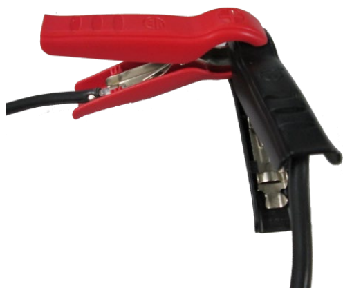
3. ábra: Rövidzárlatú töltőcsipeszek
