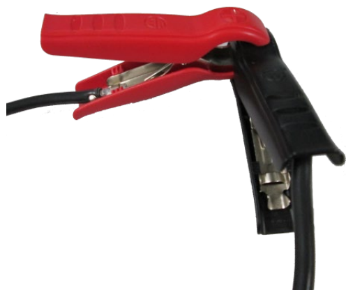
Illustration 3: court-circuitage des pinces de charge
