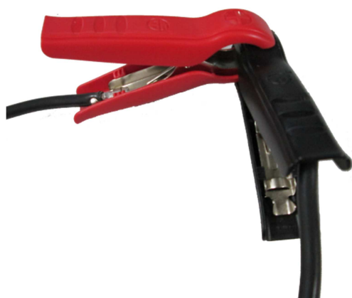
Afbeelding 3: Oplaadtangen in kortsluiting
