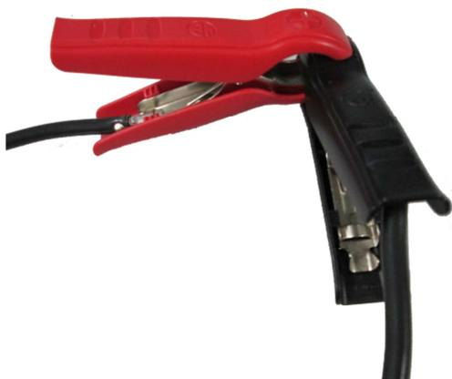
**Abbildung 4 Ladezangen im Kurzschluss**
