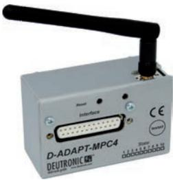
D-ADAPT-MPC4 WLAN dient zur Anbindung der DBL Batterielader (mit MPC4 Controller Bord) an ein Wireless LAN Funknetz (IEEE 802.11b/802.11g) zur Datenübertragung mit max. 11 Mbps. Der Adapter unterstützt u.a. WEP/WPA/WPA2 sowie RADIUS-Server Authentifikation / PSK (Pre-Shared-Keys).
