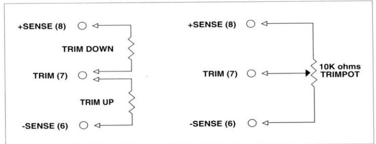
**Hinweis:** Soll External Output Trimming nicht benutzt werden, bleibt der PIN unbeschaltet, die Sense-PINs sollten jeweils mit +OUT und –OUT verbunden werden.
