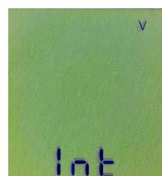
2. Source selection „Digital Input“ (like RS232, Ethernet etc)
