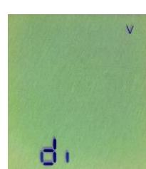
2. Source selection „Digital Input“ (like RS232, Ethernet etc.)
